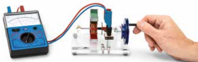
Betrieb als DC-Generator
