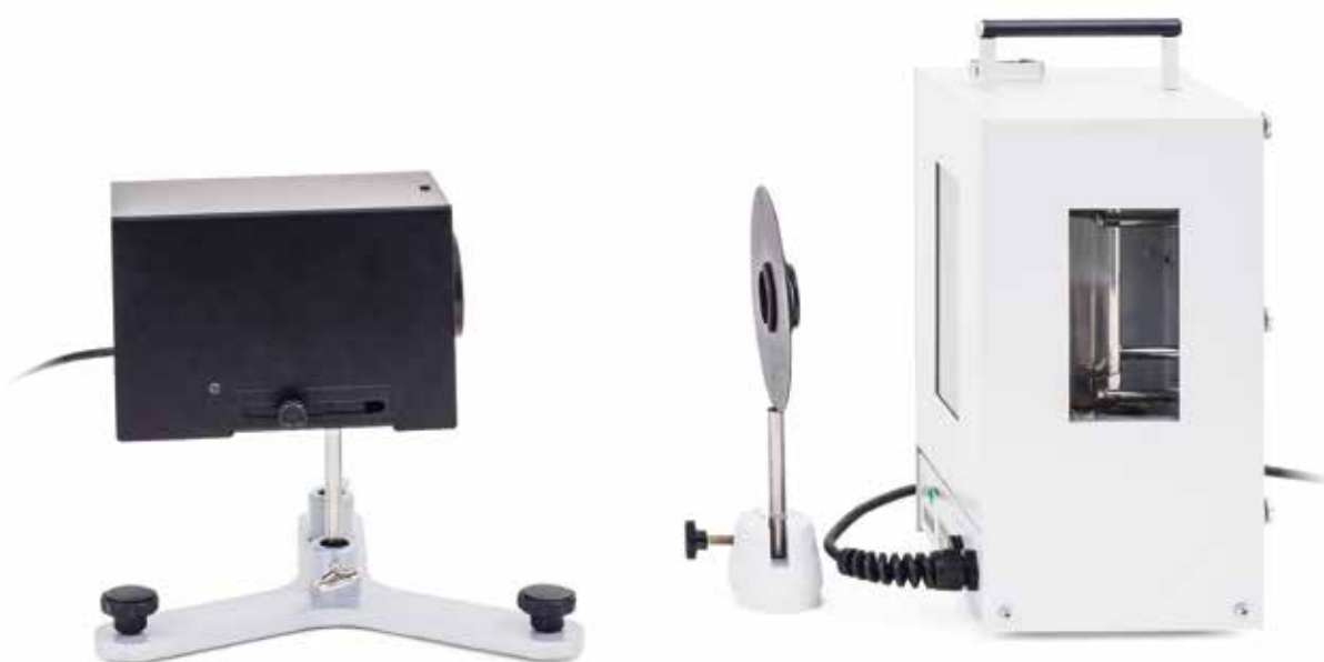
Experimenteller Aufbau zu Durchleuchtung der Natrium-Fluoreszenz-Röhre mit gebündeltem weißem Licht
