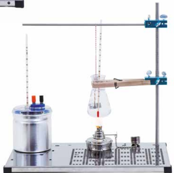
Spezifische Wärmekapazität von Metallen
