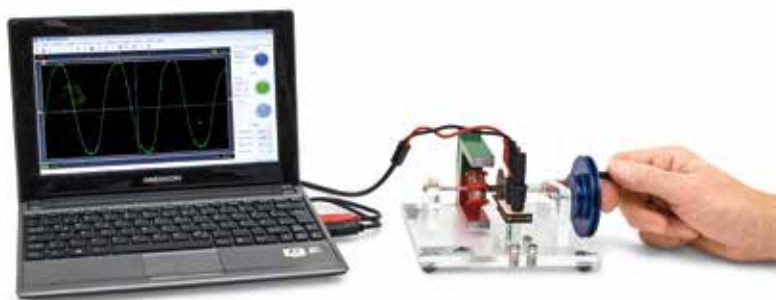
Betrieb als AC-Generator
