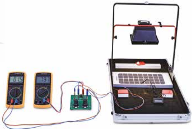
Temperaturabhängigkeit der Leistung von Solarmodulen
